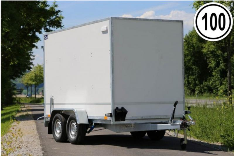
Außenmaße des Koffers mit Heckklappe: L: 460cm x B: 202cm x H: 235cm
